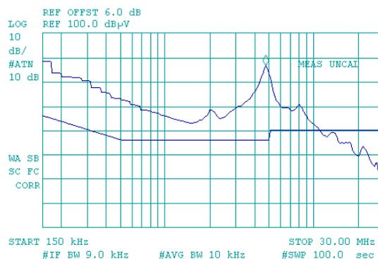
Fig. # 1 480 VAC 8 Amp. Load No Filter
